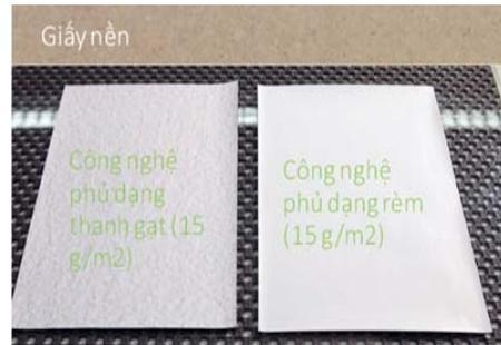
**Hình 7: Công nghệ phủ dạng rèm cho bề mặt giấy tốt hơn**
