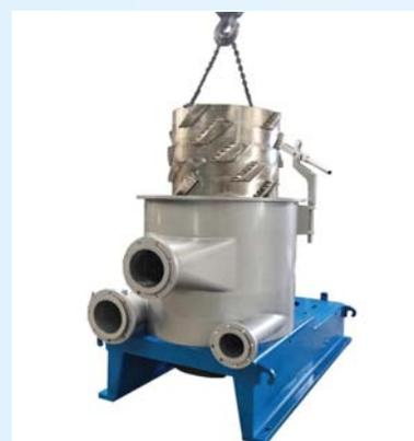
Hình 3: Cấu tạo dao gạt trên rotor sàng PSTU
